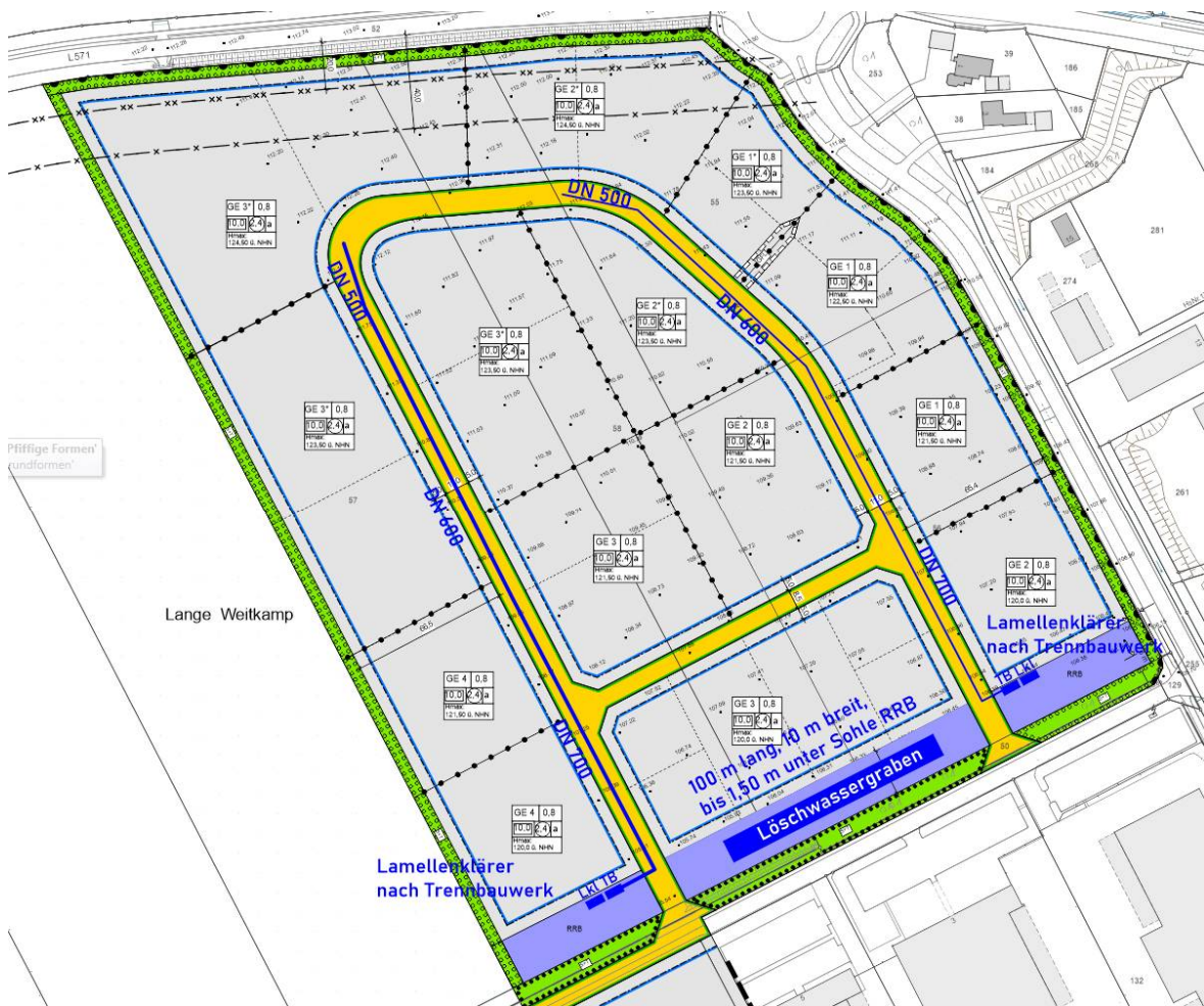
Abb. 5c: Regenwassererschließung mit RKB über Lamellenklärung und Löschwassergraben im Mittelteil des RRBs
